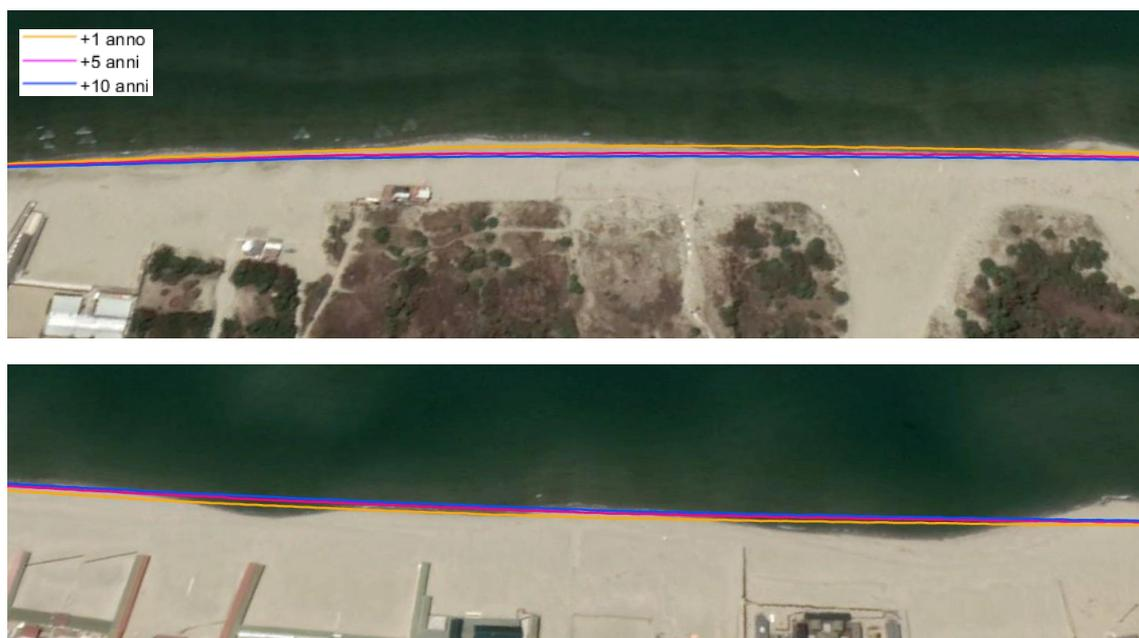
Figura 7-11 Evoluzione della linea di riva nel tratto di maggiore arretramento (sopra) e maggiore avanzamento (sotto) con riferimento alla configurazione di progetto "layout nuovo"
