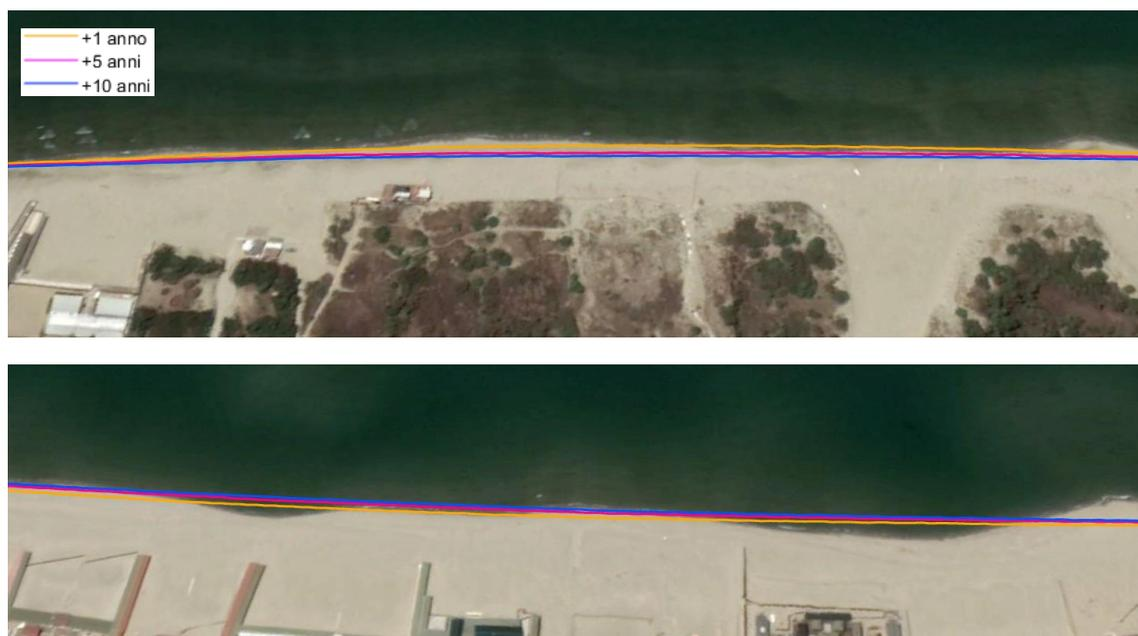
Figura 8-8 Evoluzione della linea di riva nel tratto di maggiore arretramento (sopra) e maggiore avanzamento (sotto) con riferimento alla configurazione di progetto “layout nuovo”
