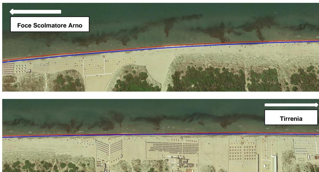
Figura 8-3 Dettaglio della calibrazione per il tratto di costa di Calambrone: In rosso la linea di riva di partenza (Giugno 2019) in blu la linea di riva al termine del periodo di calibrazione (Aprile 2020). L'immagine satellitare si riferisce al periodo Aprile 2020
