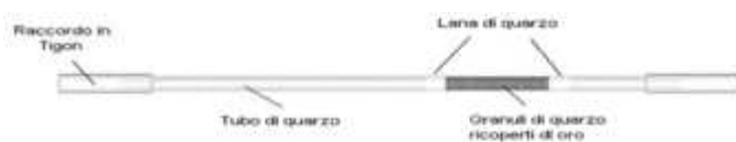
Fig.1 SCHEMA TRAPPOLA DI CAMPIONAMENTO.
